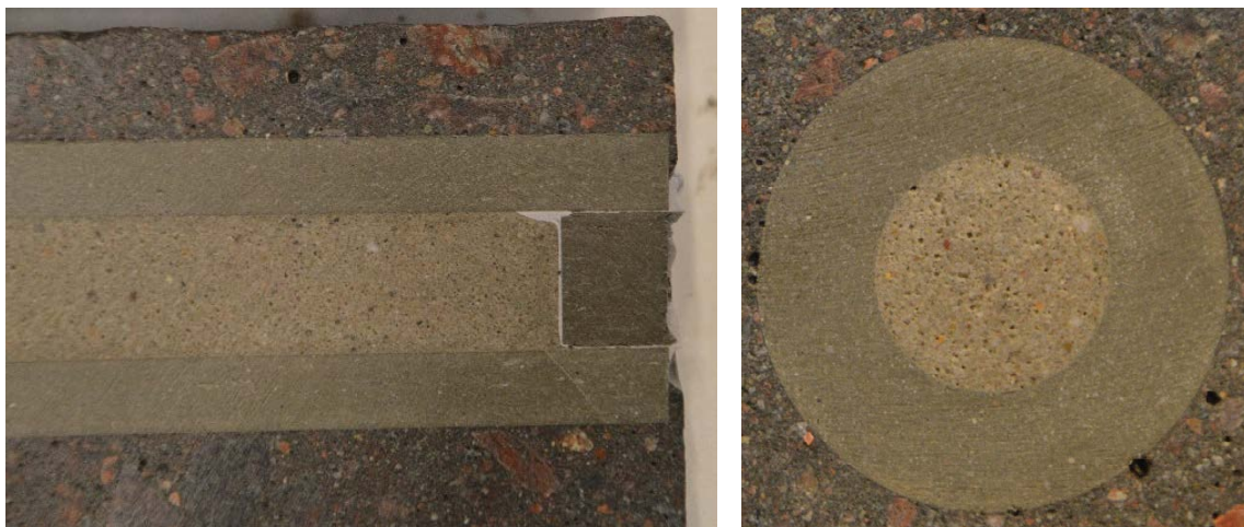
Figur 9-2. Tvärsnitt av en borrkärna från test av olika koncept för möjliggörande av användning av formsteg vid uppförande av form till ytterväggar till kassunerna i 2BMA (Mårtensson 2021a).
