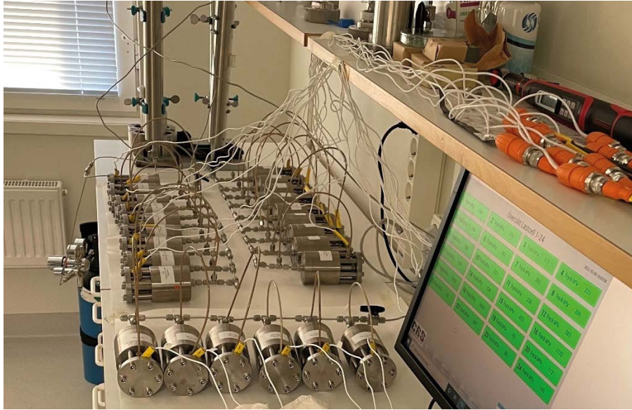
Figur 10-7. Försöksceller med bentonit, koppar och mikrober under vattenmättnad. Efter vattenmättnaden tillsätts näringsämnen och sulfat. Sulfidbildning på koppar som funktion av bentonitens densitet kan sedan mätas.
