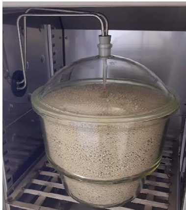
Figur 10-2. Testutrustning med glaskärl i värmeskåp (vänster). Gassammansättningens utveckling vid uppvärmning av en Milosbentonit med vattenkvot ~17 % och temperatur 70 °C (höger). Från Åkesson och Laitinen (2022).
