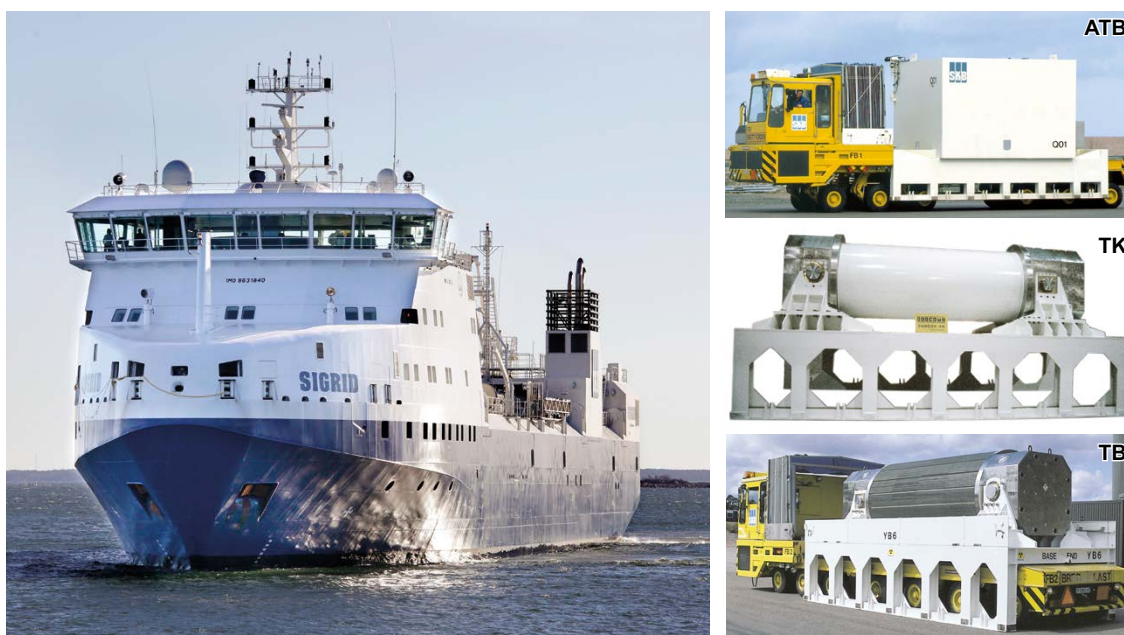
Figur 2-8. SKB:s transportsystem utgörs idag av fartyget m/s Sigrid, terminalfordon samt avfallstransportbehållare (ATB) för kortlivat radioaktivt avfall, härdkomponenter (TK), och använda bränsleelement (TB).
